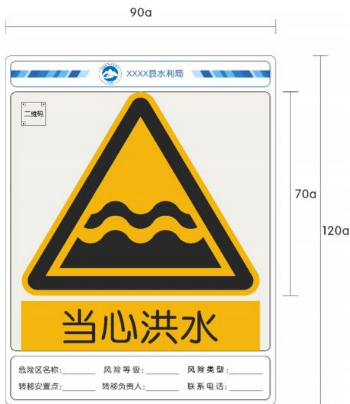
图 3.7-1 危险区警示牌当心洪水
